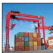
RTG (puentes grúa sobre neumáticos)
